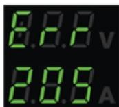
L'esempio indicato nella figura a sinistra indica un guasto alla tensione di alimentazione nel generatore.
