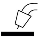
Un arco fonde un filo alimentato in modo continuo. Il bagno di saldatura viene protetto dal gas di protezione.
